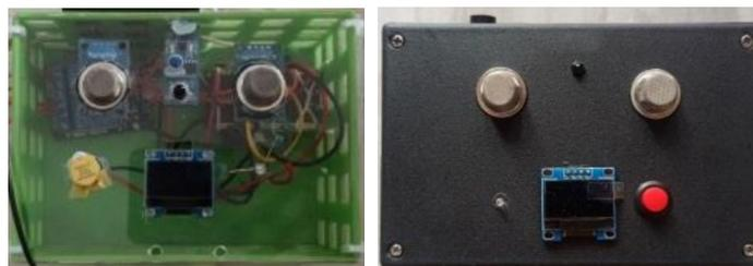
Gambar 4. Prototype pemantauan kebocoran gas LPG dan kebakaran
